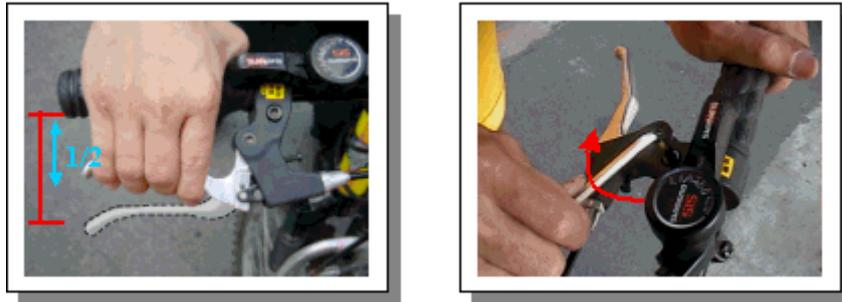
左圖：剎車拉桿的距離，最大約總行程(把手底部至剎車拉桿)的 1/2。
