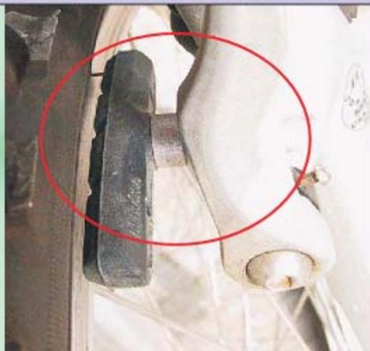
目視煞車塊有無破裂、歪斜或磨損。
